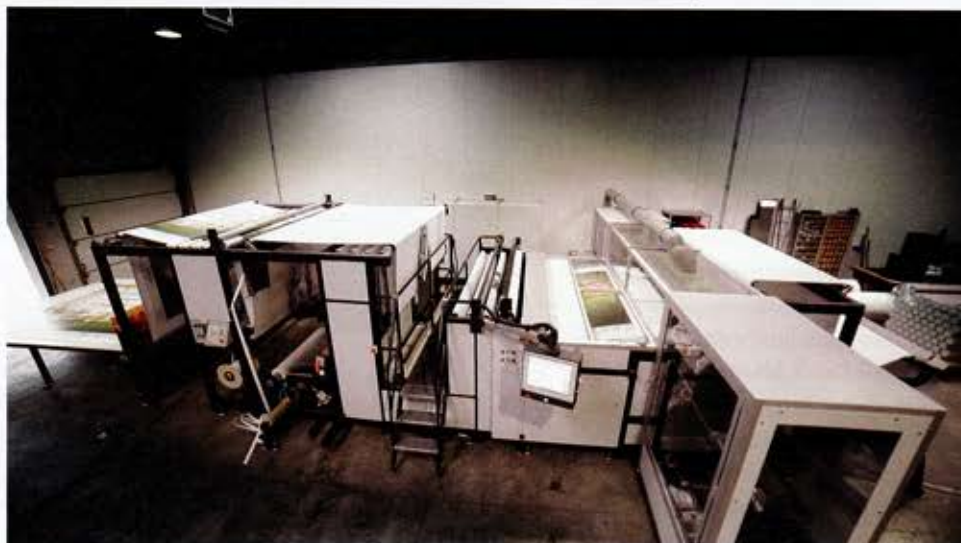
Ein MegaLight musste bisher zahlreiche Produktionsschritte und Maschinen durchlaufen. Bei Ellerhold werden die Plakate gedruckt, inline kaschiert und auf Maß geschnitten - alles in einem Durchgang.
